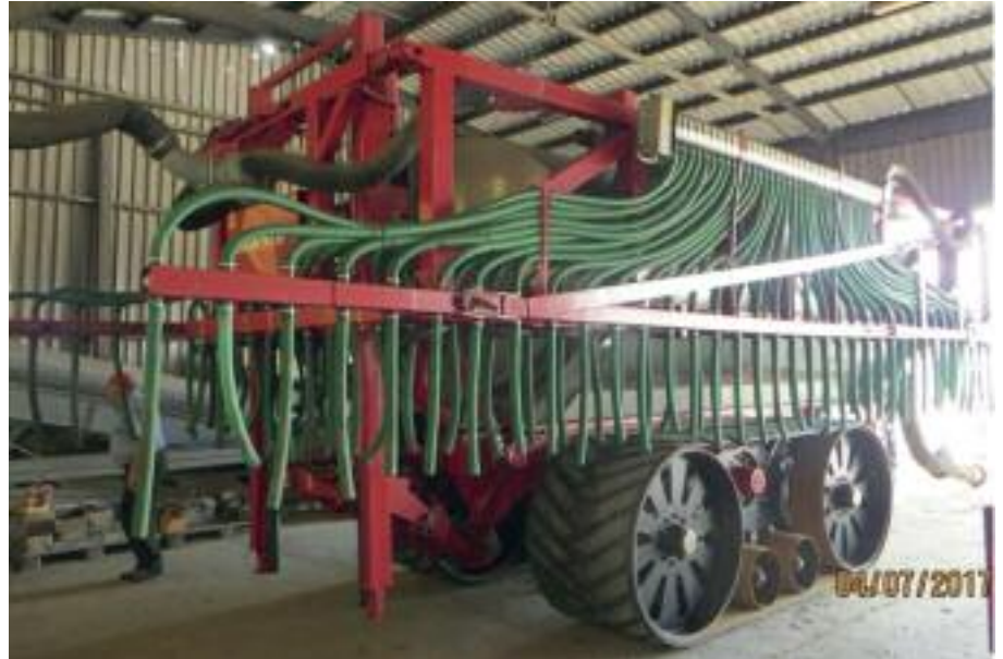
Alle Geräte und Maschinen sind auf den Fahrgassenabstand von 36 m abgestimmt. Minimaler Bodendruck hat oberste Priorität, deshalb Gummilaufbänder auch am Güllefass.
